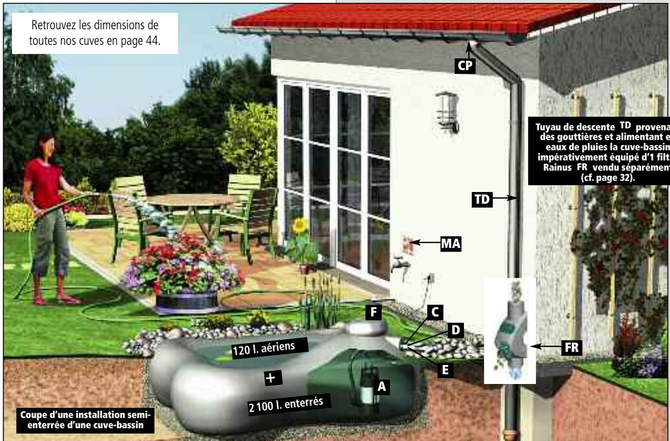
Tuyau de descente TD provenant des gouttières et alimentant en eaux de pluies la cuve-bassin impérativement équipé d'un filtre Rainus FR vendu séparément (cf. page 32).
