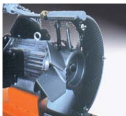
Ventilateur avec refroidisseur circulaire
