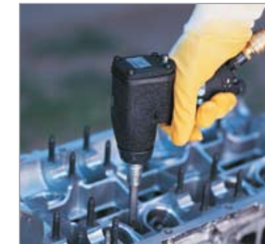
Serrage et desserrage pour les travaux de réparation
